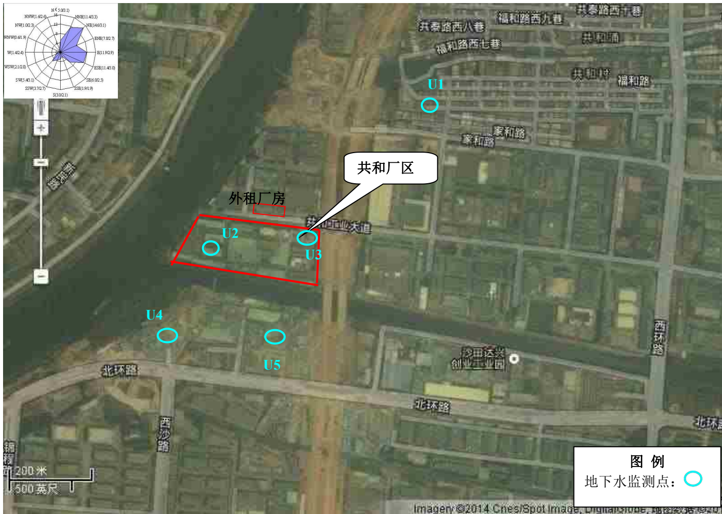
图 5.2-6 沙井共和厂区地下水监测点
